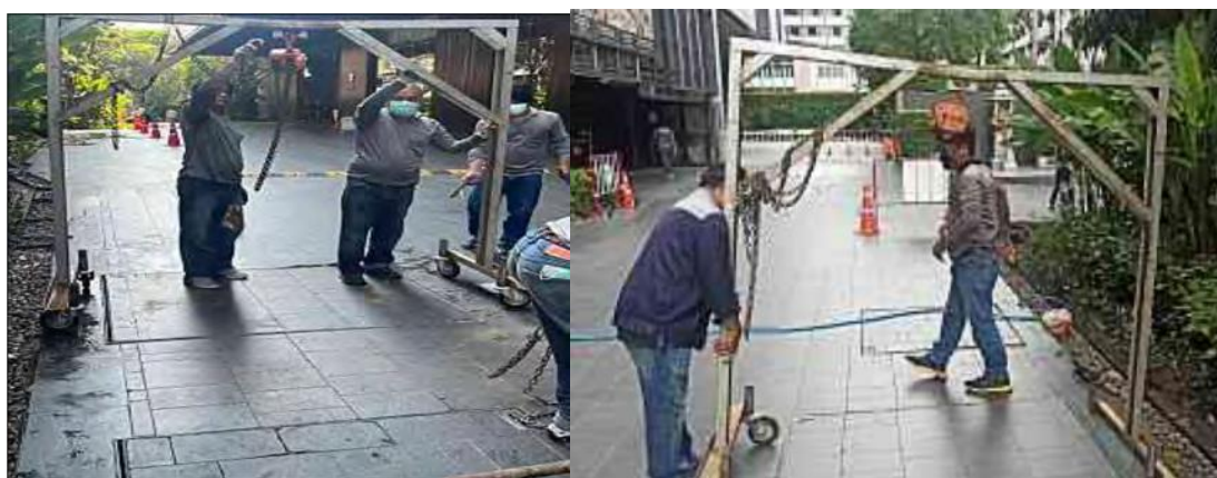
รูปที่ 3.5.2-1 การเก็บตัวอย่างคุณภาพน้ำทิ้งบริเวณบ่อบำบัดน้ำสุดท้ายในส่วนโรงแรม
